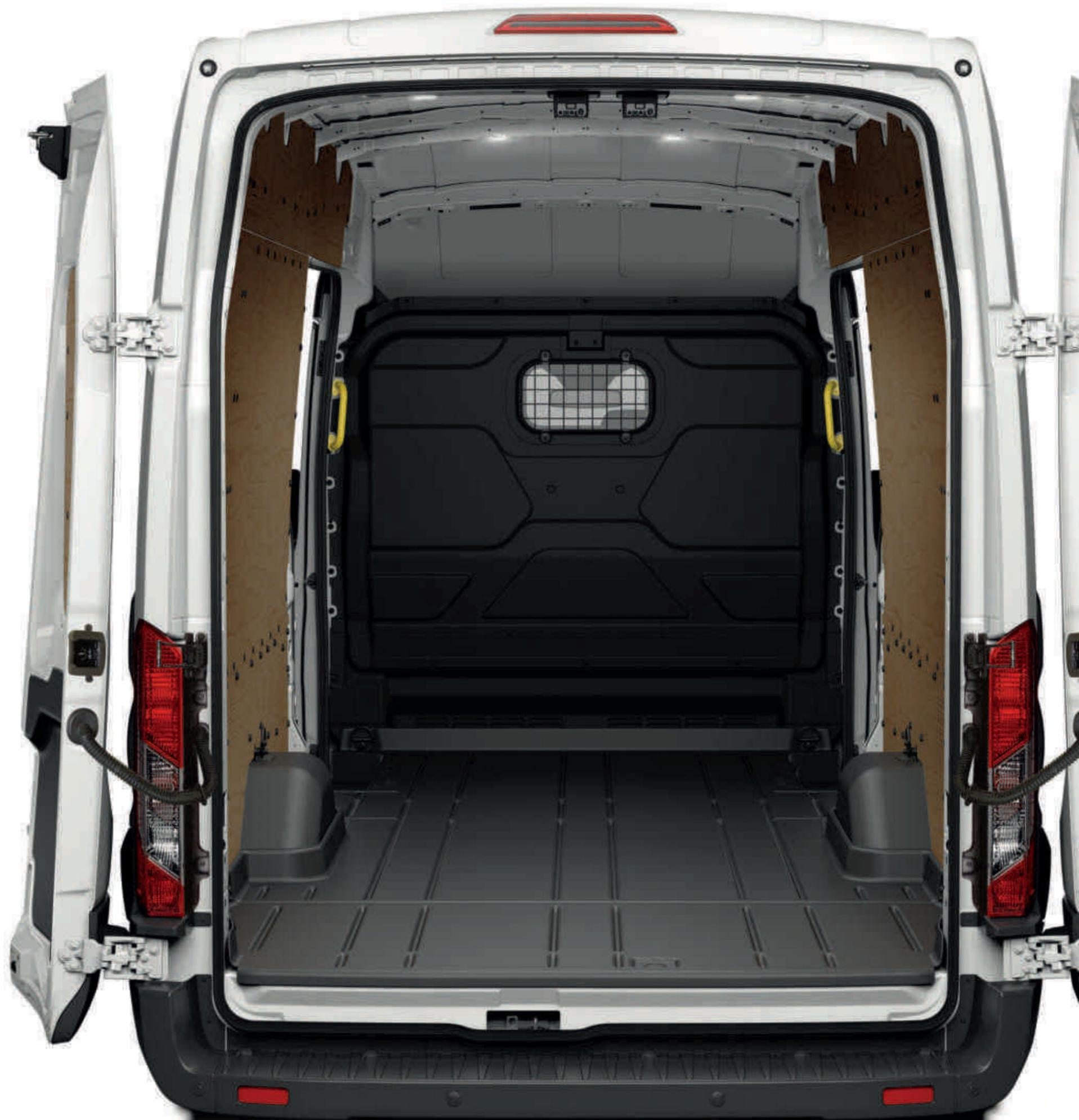
Zobrazený model je Ford Transit Trend L4 H3 „Jumbo“ s prosklenou ocelovou přepážkou a LED osvětlením nákladového prostoru.
