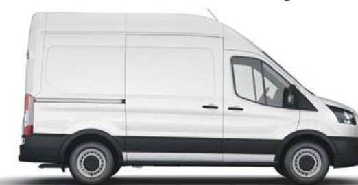
L2H3 - Média Teto Alto Furgão com capacidade volumétrica de carga de 10,7m³ e categoria "B" de habilitação.
