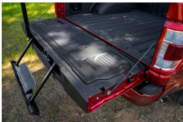
Caçamba com escada de acesso, iluminação, tomada, nichos trancáveis e revestida com protetor
