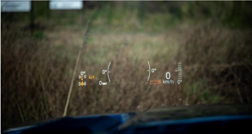
Head up display: tecnologia que projeta as informações do veículo diretamente no parabrisa.
