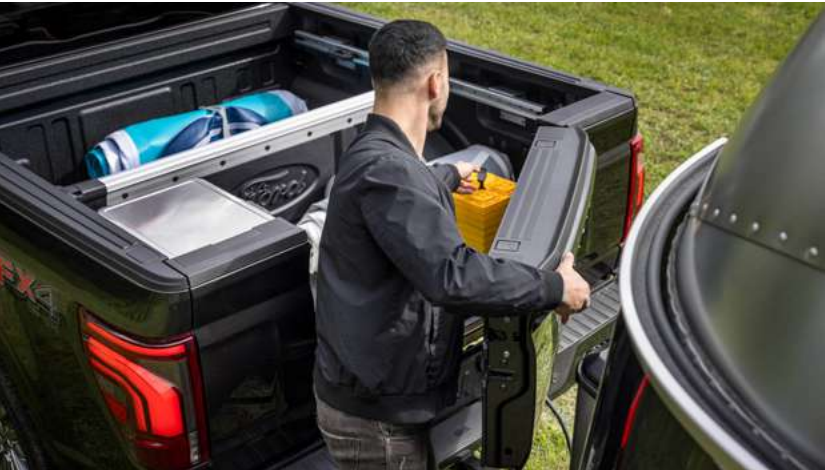
Caçamba revestida com iluminação, tomada 12V, nichos com trava e abertura lateral multiacesso (Pro-Access).
